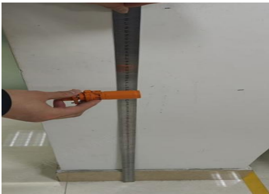
图31 机械强度撞击测试
